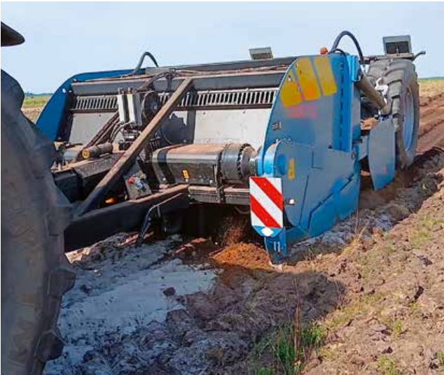
Tiefspatenfräse bei Meliorationsarbeiten
