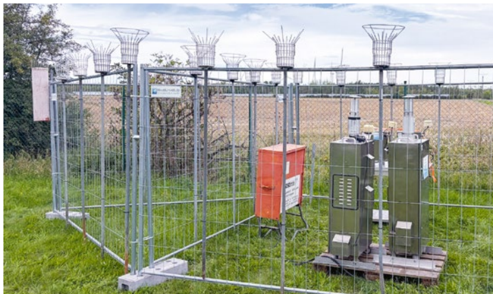
Messstation zur kontinuierlichen Überwachung der Luftqualität rund um den Kohlebrand im Kohletrübebecken I – hier in Mumsdorf bei Meuselwitz
