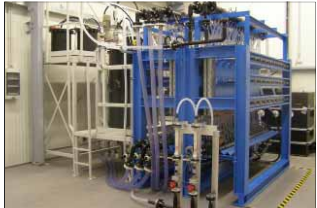
Das Herzstück der Pilotanlage sind die Elektrolysezellen.
