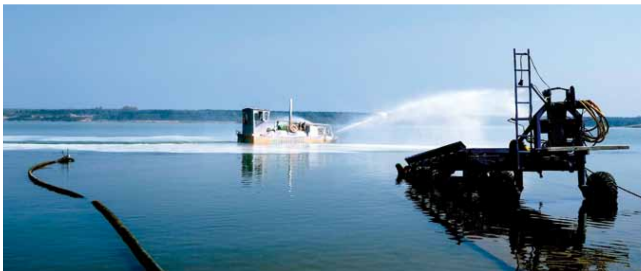
Sanierungsschiff beim Versprühen einer Kalksteinmehl-Wasser-Lösung auf dem Haselbacher See; links im Bild: die Versorgungsleitung.
