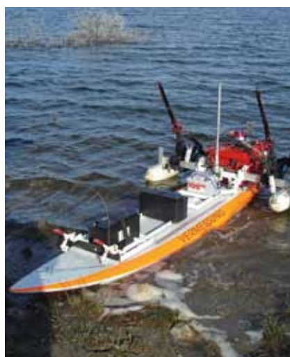
Fernsteuerbare Lotungstechnik im Einsatz.
