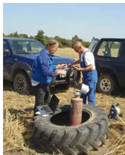
Setzen von zusätzlichen Messsonden.
